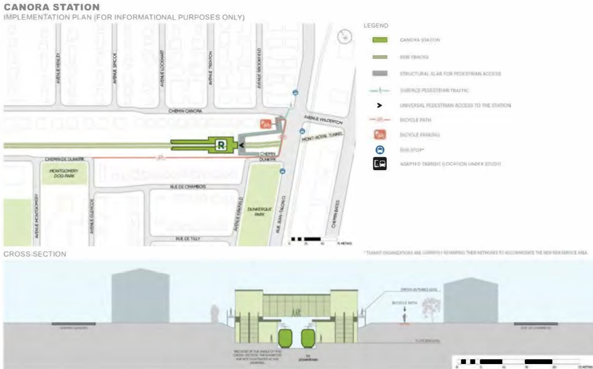
Figure 35 : Plan et coupe de la station Canora à Ville Mont-Royal.
